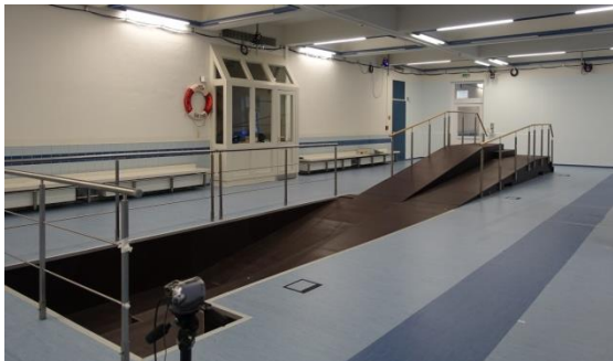
Abbildung 1: Das Labor für Bewegungsanalyse an der Orthopädie Heidelberg mit der Möglichkeit für unterschiedliche Gangkonditionen, wie dem Gehen in der Ebene und auf Rampen.
